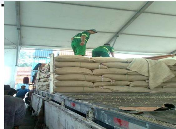
**Necessário que exista espaço suficiente para a circulação de ar entre o teto do container e as sacas, bem como entre as sacas e a porta do container.**
