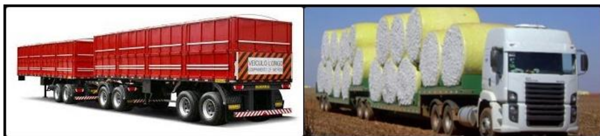
Figura 13. Na esquerda rodotrem de com capacidade de 74 toneladas, na direita caminhão prancha usado para levar o algodão até a beneficiadora. Fonte: Santa Izabel (2012).
