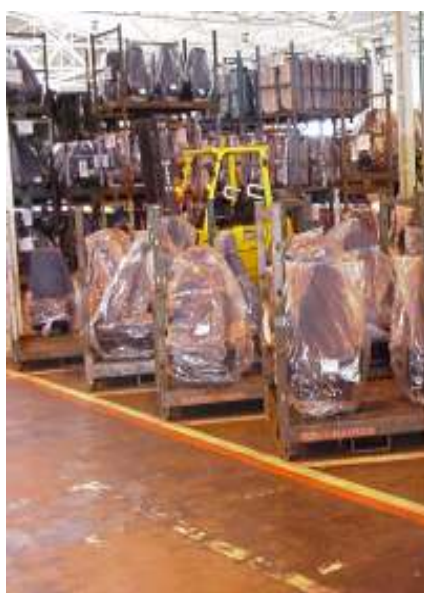
Figura 15 – Foto ilustrativa do modelo de produção just in sequence , para o caso de bancos de caminhões.
